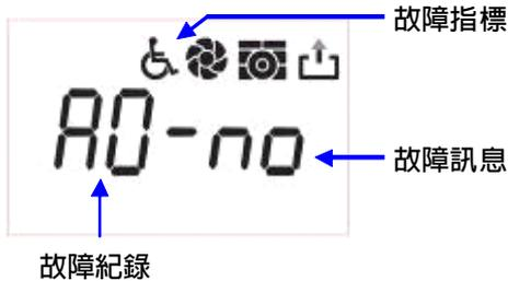
當故障發生時，操作面板會自動進入故障顯示模式（若配置的是 COLOR 型的面板，會顯示醒目的紅色背光警告），並顯示出當前發生故障的紀錄內容。故障顯示主要的是紀錄的顯示以及故障的代碼顯示。
