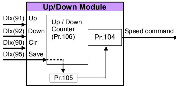
依照上列的圖示設定好各相關參數。速度上升 / 下降計數器的起始輸出值可經由 Pr.104 選擇從 0 開始或自動將 Pr.105 的儲存值載入作為起始的輸出值。
