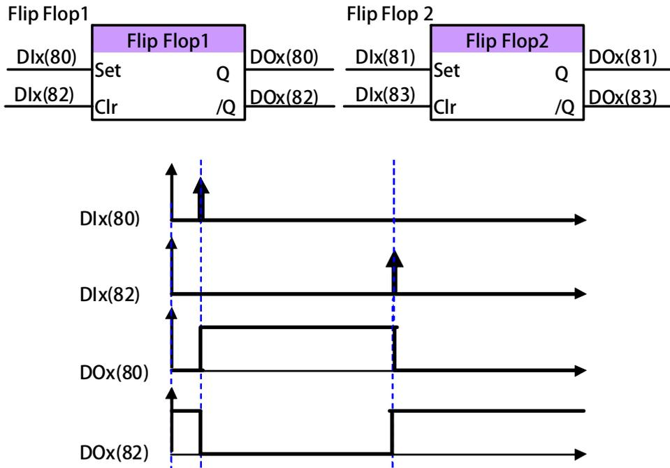
驅動器中內含一般用途的正反器。每個正反器中需要兩個輸入端子，及兩個輸出端子
