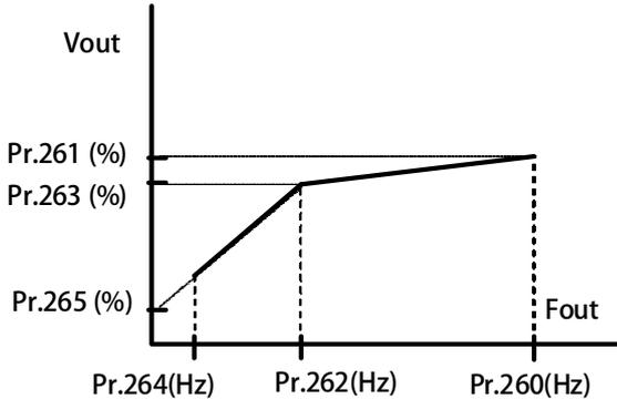
以上 6 個參數的使用方法及定義請參考上圖所示。在 V/F 圖形以上述 6 個參數定義的曲線中，分別定義了驅動器在各個頻率段落中的輸出電壓%值。驅動器則依照此曲線定義在不同的頻率下有不同的輸出電壓值。定義此曲線可以控制馬達輸出的扭力及功率以及改善效率等效果。
