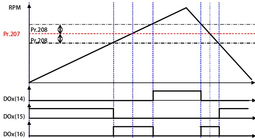
範例：假設 Pr.207=1000rpm，Pr.208=100rpm。
